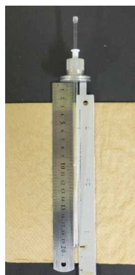
図 1 試料設置位置の調整 サンプルゲージの印を試料管への充填高さの中心に合わせる。
