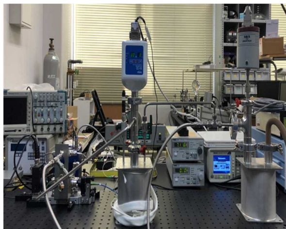
図4 左図: JST-JAXA 宇宙探査イノベーションハブ(2016-2019)にて開発された共振器長5cmの小型CRDS装置: ((株)神栄テクノロジー、産総研、阪大、茨城大、鹿児島大)、右図: 小型CRDS法による水同位体測定装置
